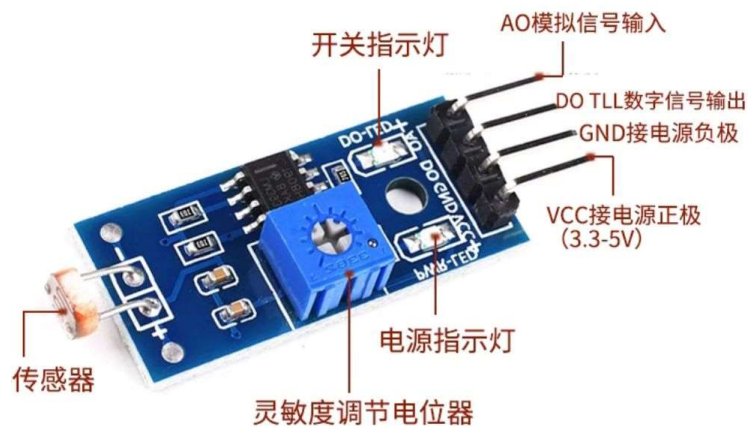
图 8 光敏传感器实物图及引脚功能
