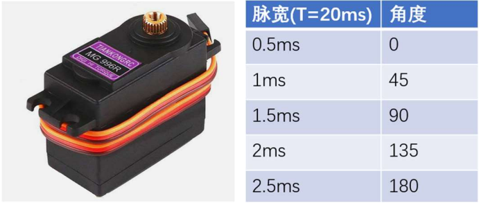
图 12 MG996R 实物图及工作原理
